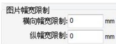
**G1. 横向幅宽限制：**横向打印幅数的宽度限制，当横向需要打印的任务超过了打印材料长度时，需要进行对总打印幅宽的限制
