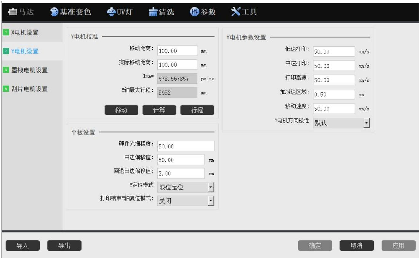
**A. Y 电机校准：**Y 轴的校准特指打印材料的校准，与 X 轴不同，打印材料需要自己手动量取实际的移动距离来进行校准
