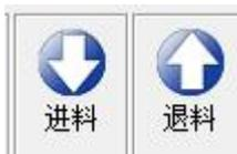
**B4. Y 电机方向极性：**调整打印材料的前进以及后退，选择默认保持正常进料退料；选择全部取反则将所有移动打印材料时的相反；选择运动取反，仅在走料时反过来
