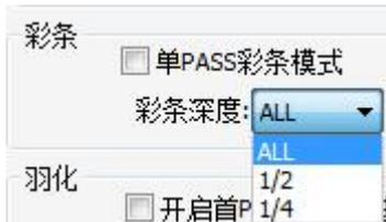
**I1. 单 PASS 彩条模式：**开启后，将先按照当前打印任务的 PASS 数来打印彩条，可通过打印的彩条查看喷头有无堵孔，或出现断墨等情况，也可以防止在打印过程中出现断墨等情况
