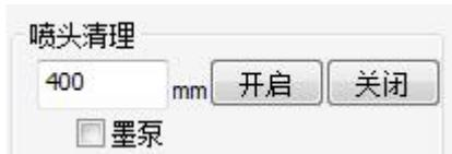
开启：点击开启，小车移至设置值，勾选墨泵，墨泵工作，抽掉墨垫中的废墨
