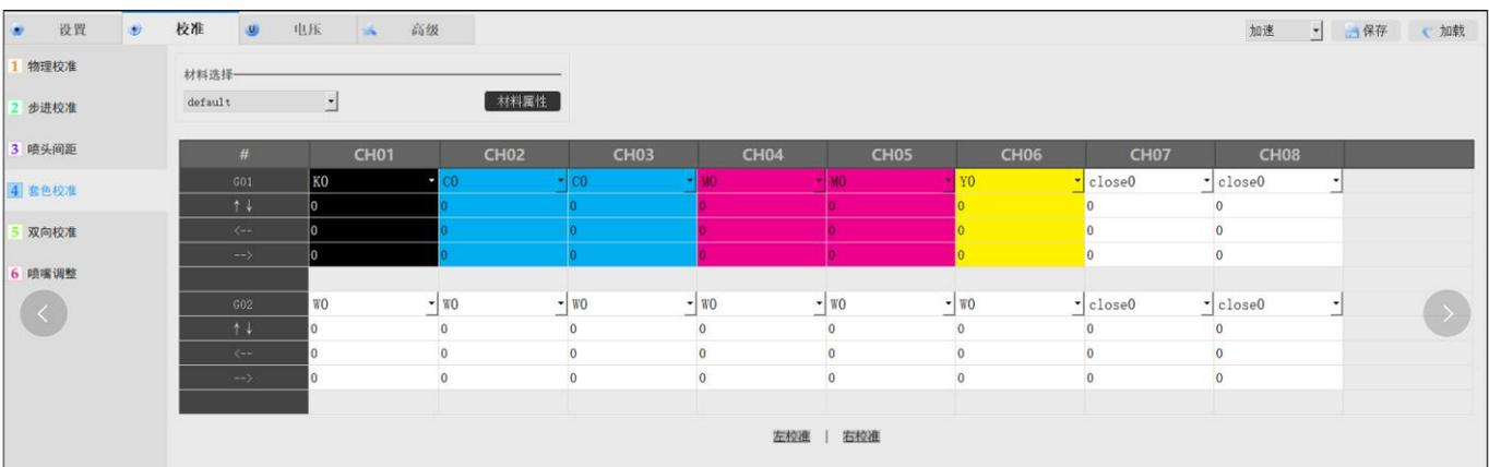
套色校准：喷头的颜色偏移，分为喷头向左打印偏移和向右打印偏移
