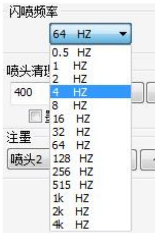
频率越高，喷孔闪喷的力度也越大，反之则越小
