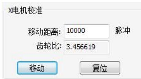
首先确认光栅解码器读值正常，左移观察左下方 X 显示位置值，如  $x: -0.11mm$  到  $x: 164.66mm$ ，然后点击《X 复位》。然后，点击《移动》，小车则会向左移动（默认右边是原点的情况下），等小车停止运动以后，点击《复位》，小车回到原点，X 齿轮比校准完成
