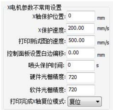
**C1. X 轴保护位置：** 小车在回到原点前，为了防止发生惯性的碰撞，可在此设置一个值来让小车处于保护位
