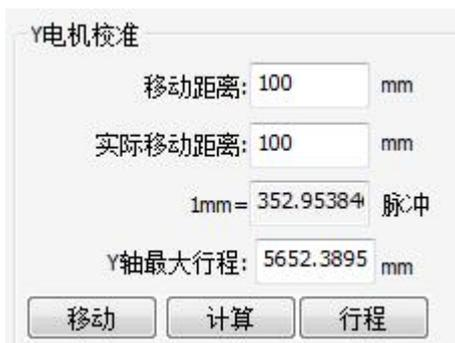
先提前在打印材料上用笔做个标记，再点击移动，打印材料会向前运动一段距离，停止运动后，用工具量取打印材料刚刚实际走动的距离，将得到的数值写入，点击计算，得到 Y 的齿轮比。需要进行多次校准，当运动值和测量是值一致时，说明数值越准确
