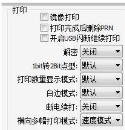
**A1. 镜像打印：**按照打印任务在镜像中的状态进行打印
