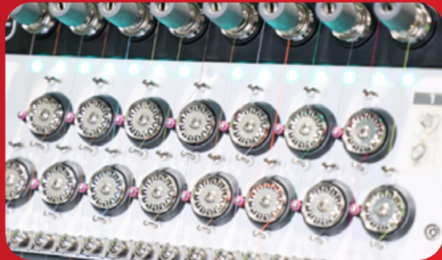
磁编断检 及时发现问题隐患, 有效防止意外停机, 确保刺绣流程连续稳定
