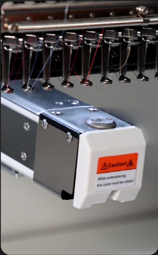
小梭箱设计 小梭箱设计让你应对袖口、口袋和其他难以夹框的绣品时也能得心应手, 拓展从小配饰到精细的服装作品等更多项目的可能性
