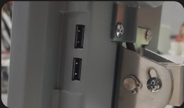
嵌入式USB设计 防止USB端口损坏
