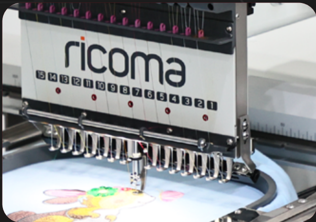
加强面线夹 确保剪线的稳定性
