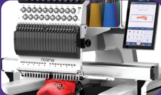
更大的刺绣面积 (800 x 520 mm) 满足大图案的创作需求 轻松应对包括夹克、包袋等大件物品
