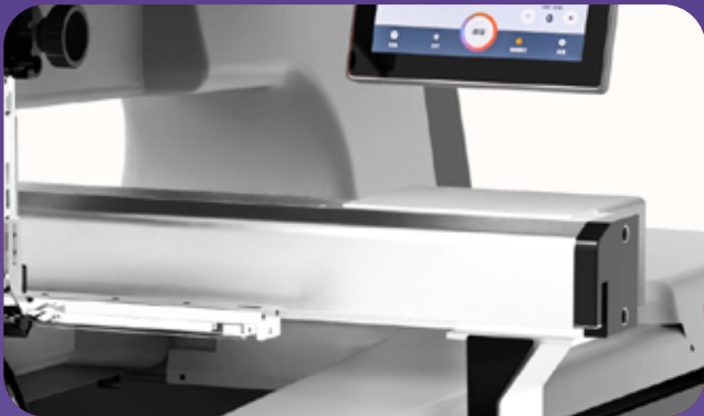
直线导轨 隐藏式走线,高速、稳定
