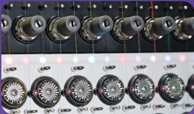
具有断线检测功能的RGB 彩灯精准显示线的颜色,并在断线时快速闪烁报警
