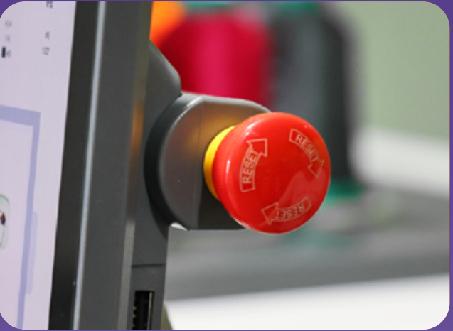
急停按钮 在发生紧急情况时,以最快、最直接的方式让机器瞬间停止所有操作,防止人员受伤或设备损坏
