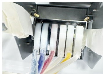
喷头进墨管的排列方式 K C M Y W
