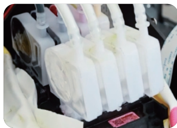
喷头进墨管的排列方式 K C M Y W W W
