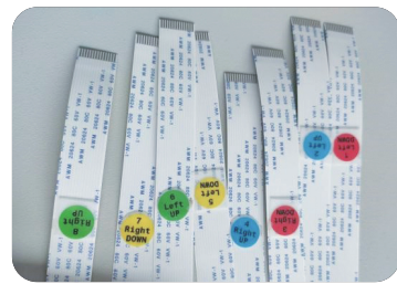
数据线：喷头和头板的 14 芯扁平线，一个喷头 需要 4 根
