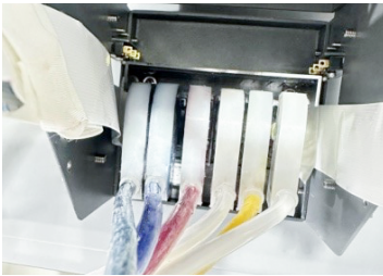
喷头进墨管的排列方式 K C M W Y W
