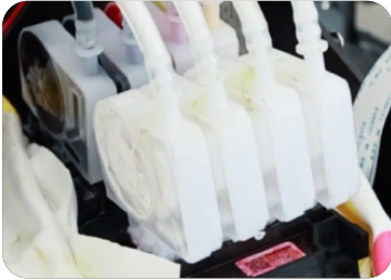
喷头进墨管的排列方式 K C M Y W W W W
